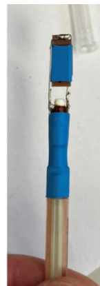
Fig.35 Circuit TDO integrabile in MPMS3 cu condensatori cu electrozi PCB/Cu si dielectric pe baza de SCO
