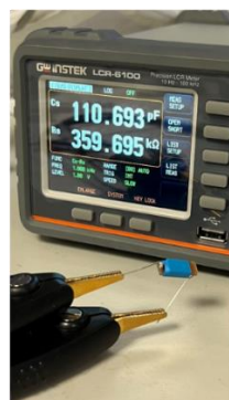
Fig.35 Circuit TDO integrabile in MPMS3 cu condensatori cu electrozi PCB/Cu si dielectric pe baza de SCO
