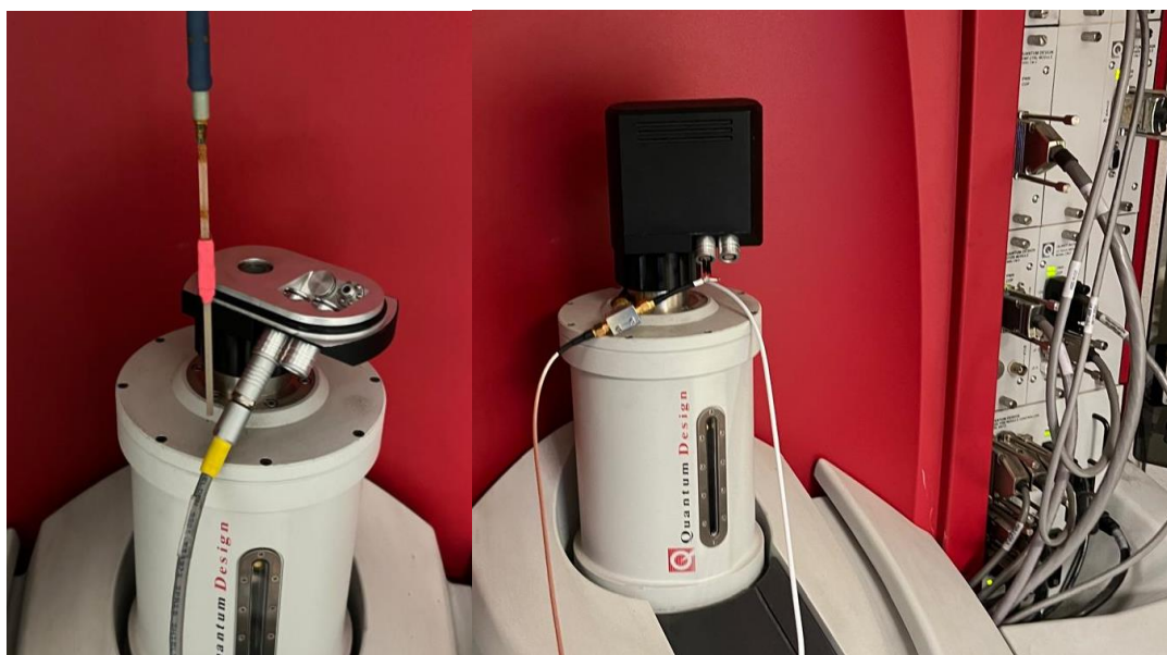
Fig.23 Setup TDO in criostatul cu He ( T < 10K ) MPMS3 pentru măsurători magnetice in T si H variabile
