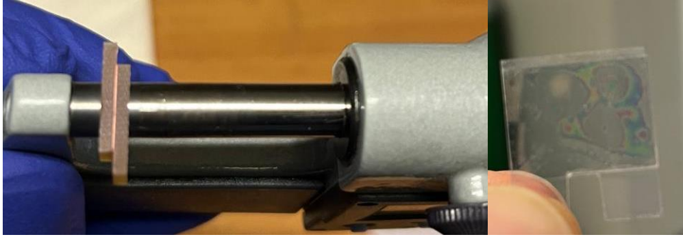
Fig.10 Condensator cu SCO+PVP cu electrozi PCB/Cu (stânga) și PET flexibil cu ITO (dreapta)
