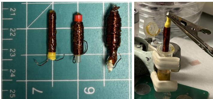
Fig.6 Imagini bobine tip solenoid cu valori ale inductanței cuprinse între 5-150 \mu\text{H} , construite cu GE Varnish.
