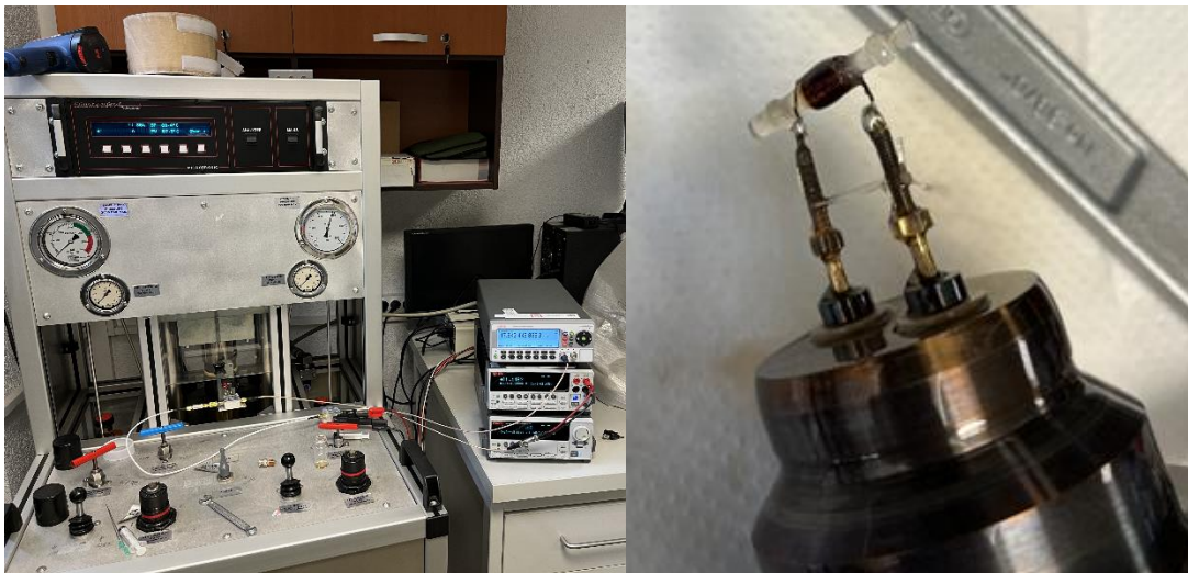
Fig.15 Setup TDO pe celula cu presiune variabila (0-3000bar) si temperatura variabila (300-523K) pentru măsurători de susceptibilitate cu bobina solenoid
